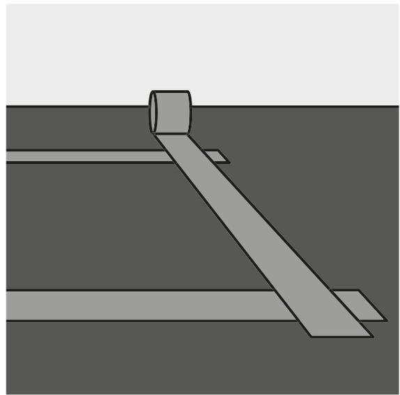
Kontur vormarkieren und mit Klebeband abkleben.
