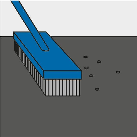
Untergrund reinigen. Die Oberfläche muss trocken, sauber und frei von Fett und Öl sein.
