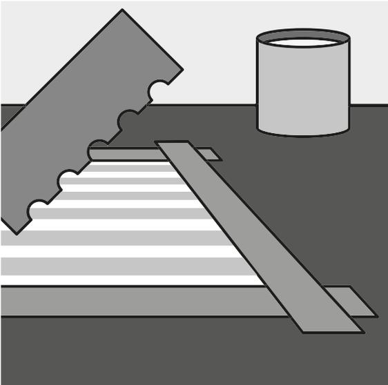
Haftvermittler in einer gleichmäßigen Schicht auftragen.
