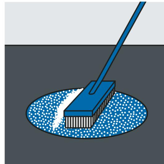
SWARCO PREFORMED mit dem Besen reinigen und die Haftung mit einem spitzen Gegenstand prüfen. Schon nach wenigen Minuten ist die Markierung befahrbar.
