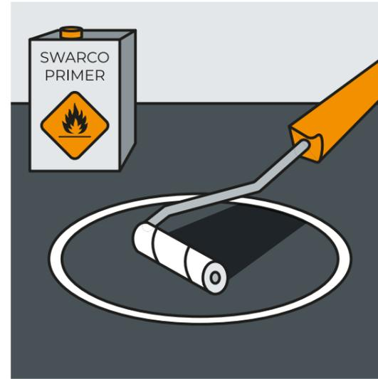
Untergrund bei Kälte und Nässe gründlich vorwärmen bzw. vortrocknen. Grundierung auftragen und ablüften lassen.
